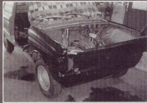
Die Scheibendichtungen blieben samt Fenstern am Auto – das Gummi wären sonst zerbröselt
