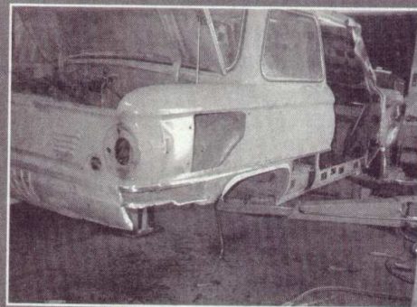
Für die hinteren Kotflügel waren Ersatzbleche nur vom Nachfolgemodell 968M aufzutreiben
